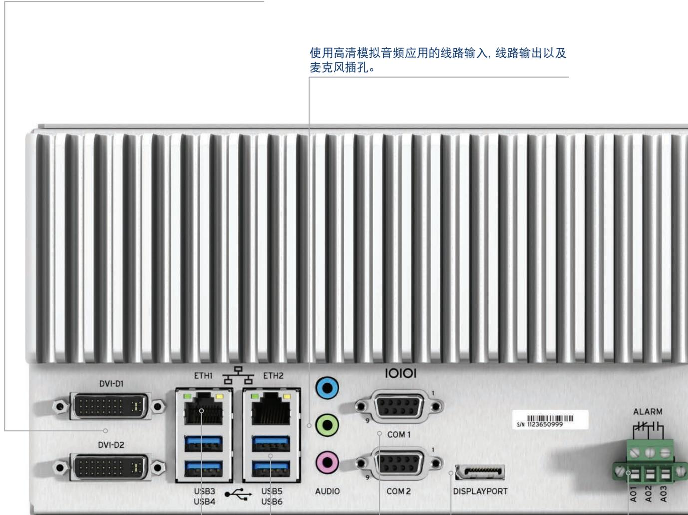
两个高速千兆以太网端口可以组合使用以实现冗余, 也可以单独使用。
