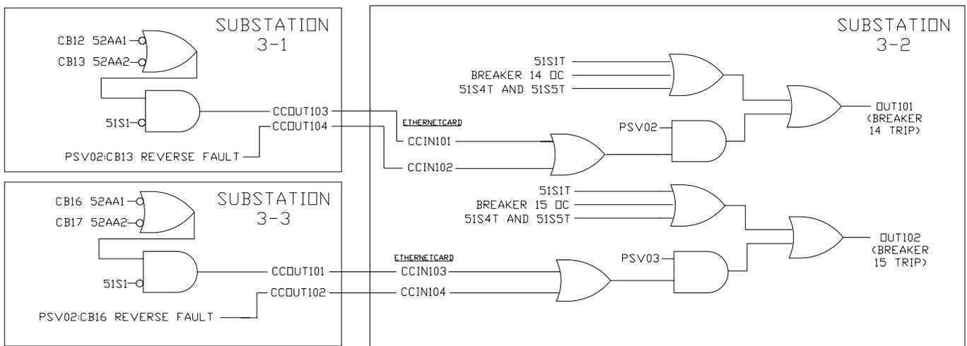
Fig. 10. Breaker Trip Logic
