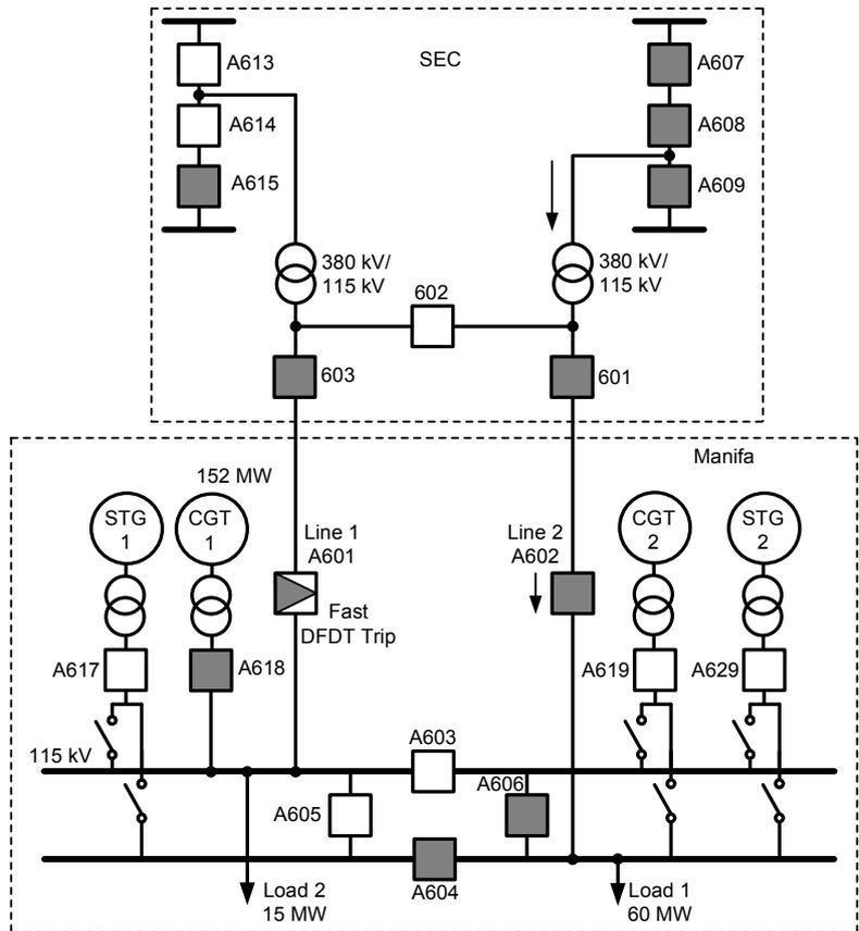
Fig. 14. Fast DFDT In-Service Operation
