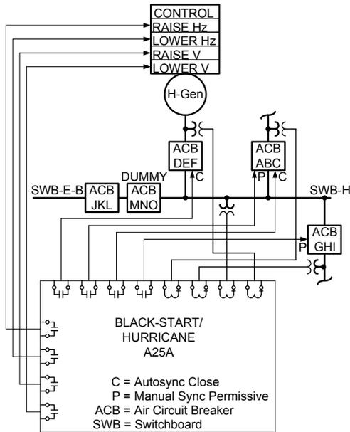
Fig. 2 Platform 1 Black-Start/Hurricane Generator A25A
