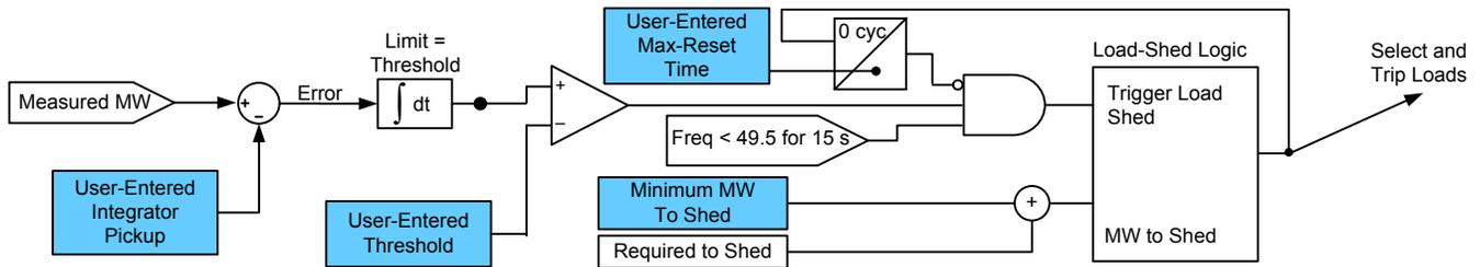
Fig. 3 Progressive Overload-Shedding Logic
