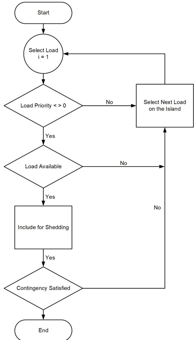
Fig. 5. Load-Selection Logic
