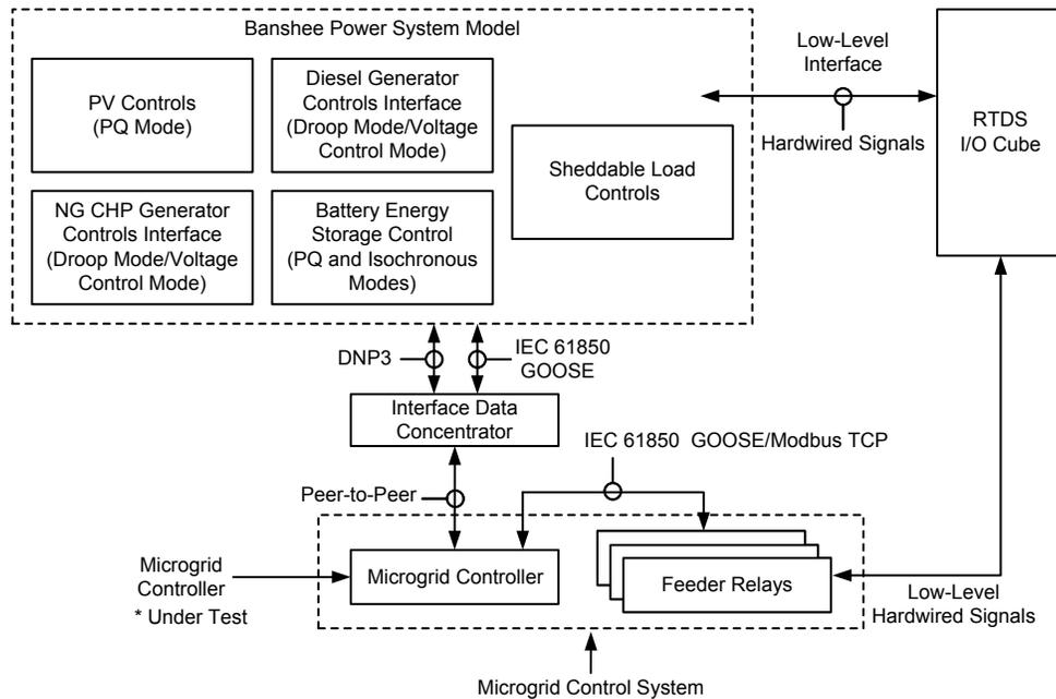
Fig. 10. HIL test setup
