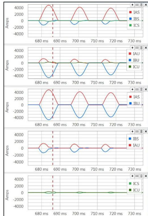
Fig. 24. PST1 87P Relay Incorrect CT Wiring
