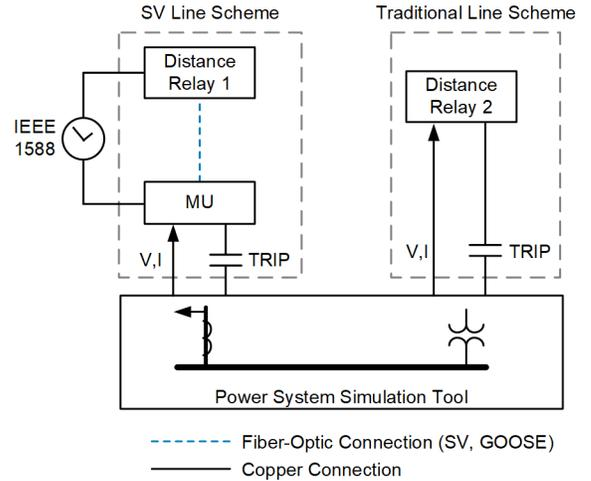
Fig. 15. Benchmark test setup
