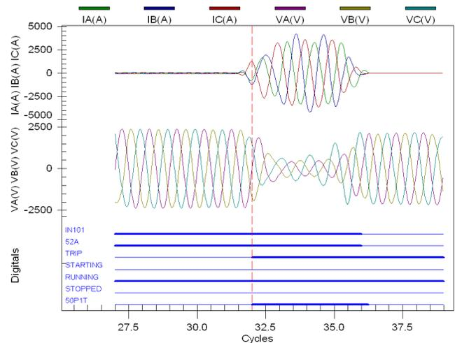
Fig. 25. Motor Trip (12 – Motor Trip 710.cev)
