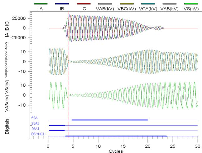
Fig. 26. Generator Close (13 – Generator Close 300G.cev)
